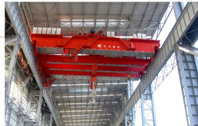
发往昆钢的150T铸造 起重机的 150t foundry crane delivered to kunlun steel
