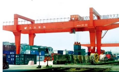
集装箱门式起重机 container gantry crane
