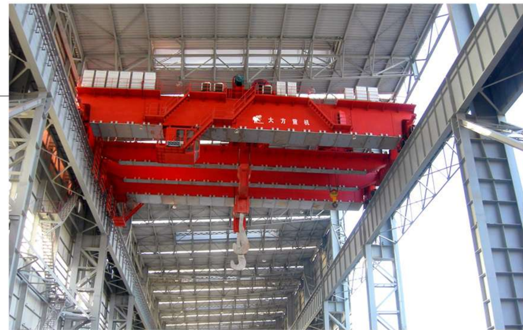
发往昆钢钢铁的150T铸造 起重机的 150t foundry crane delivered to kunlun steel
